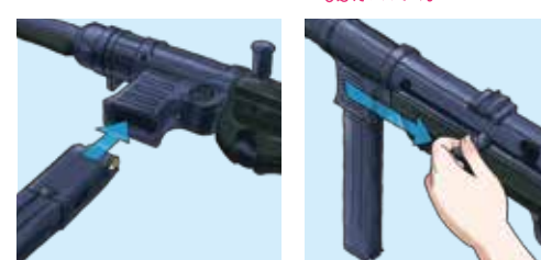
③ マガジンバマガジンキャッチを確実にかかるまで入れる ④ コッキングレバーを引く。ボルトが後退した位置で止まります。
