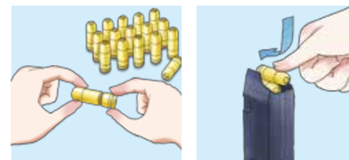
① カートリッジに火薬をセット。 ② マガジンにカートリッジを入れる。32発入ります。
